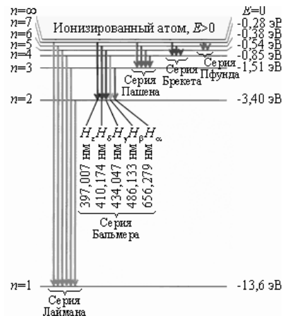
Рис. 1-11. Диаграмма энергетических уровней атома водорода. Показаны переходы, соответствующие различным спектральным сериям. Для первых пяти линий серии Бальмера в видимой части спектра указаны длины волн.
