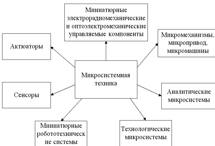
Рис. 4-8. Основные компоненты микросистемной техники
