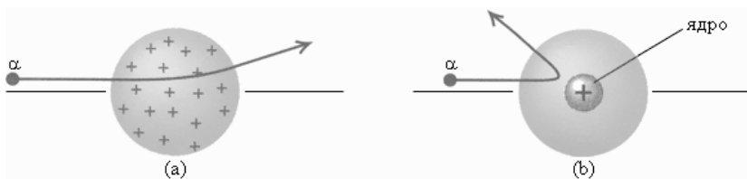
Рис. 1-7. Рассеяние \alpha -частицы в атоме Томсона (a) и в атоме Резерфорда (b).
