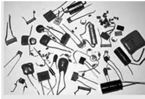
Рис. 22. Элементное исполнение различных конденсаторов.
